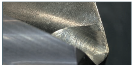
Werkzeugschneide vor dem Entschichten
